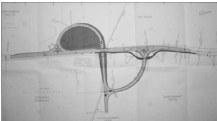
So wird die Zufahrt zum Industriegebiet im Holzfelder und Daxenthaler Forst aussehen: Die B 20 (im Plan von links nach rechts Richtung Markt verlaufend) wird auf Höhe des jetzigen Grenzgeräums unterführt; die höhengleiche Ausfahrt Richtung Markt liegt bereits auf Haiminger Gebiet. Erschlossen wird dadurch sowohl das Burghäuser
